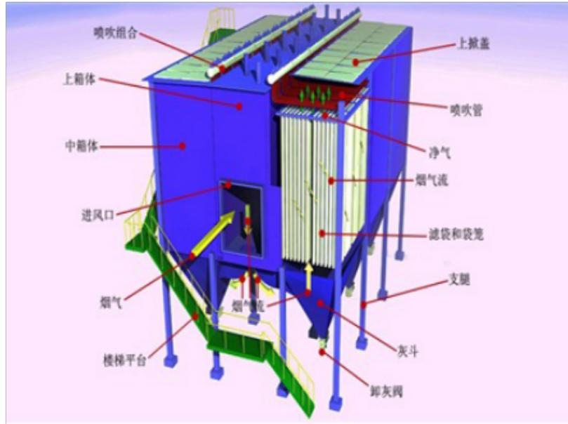
—进气口;2—电机;3—螺旋输送机;4—池尘口;5——气流分流板;6——集尘斗;7——滤尘室;8——除尘滤袋;9——花板;10——出气口。锅炉采用。为保证滤袋除尘器在锅炉不停机的工况下,正常工作或进行滤袋清灰操作,将除尘器分组为3个的滤尘室。每室安装滤袋22条,滤袋除尘可分组也可并联工作,当其中一组滤袋进行清灰操作时,其他分组滤袋则保持正常工作。烟气从除尘器下部进气口切线进入,烟气在除尘器内沿负压气道向前,一部分尘粒因重力作用沉降于集尘斗;另一部分烟气通过滤袋时,烟尘就被阻留在滤袋内,净化后气体经引风机向外排放,从而达到集除烟尘、净化气体和保护大气环境的目的。负压反吹滤袋除尘器的净化机理:是利用锅炉引风机组成除尘器系统负压,烟气负向流动。滤袋除尘器具有惯性碰撞、筛滤(接触阻留)、截捕、聚集和静电等滤尘作用,且能对粗( $\geq 10\mu\text{m}$ 粒径)、细( $<5\mu\text{m}$ 粒径的对人体危害比较大)颗粒的烟尘及悬浮微尘都能有效地捕集,这是它的突出优点。
